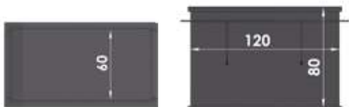
Technischacht für Gegenstromanlage
